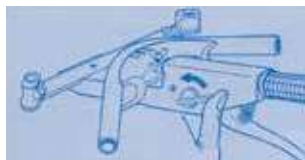
Fase 3 - Azionare la leva della pinza fino ad ottenere l'angolazione voluta.
