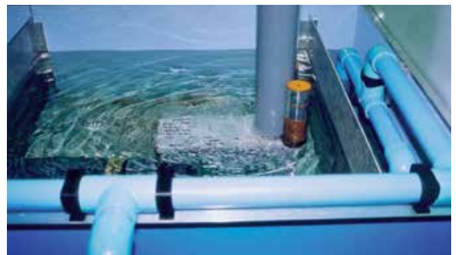
Prova di evacuazione su un pozzetto pluviale.
