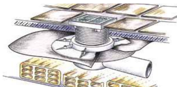
esempio di installazione con membrana impermeabilizzante
