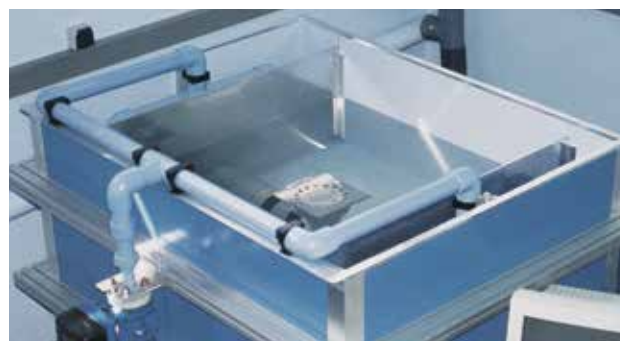
Prova di scarico su un chiusino sifonato.
