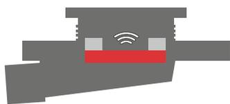
Una volta terminata la doccia il flusso diminuisce, la forza magnetica fa chiudere il piattello che si posiziona nella sua sede riempiendosi di acqua. Il battente d'acqua, che funge da seconda sifonatura, è pari a 1 cm.
