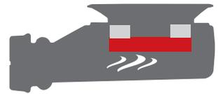
La forza magnetica mantiene ermeticamente chiuso il piattello. Il sistema di sifonatura magnetica unito al battente d'acqua assicura una tenuta totale e impedisce il reflusso di cattivi odori e lo svuotamento dei sifoni.
