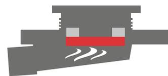
La forza magnetica mantiene ermeticamente chiuso il piattello. Il sistema di sifonatura magnetica unito al battente d'acqua assicura una tenuta totale e impedisce il reflusso di cattivi odori e lo svuotamento dei sifoni.
