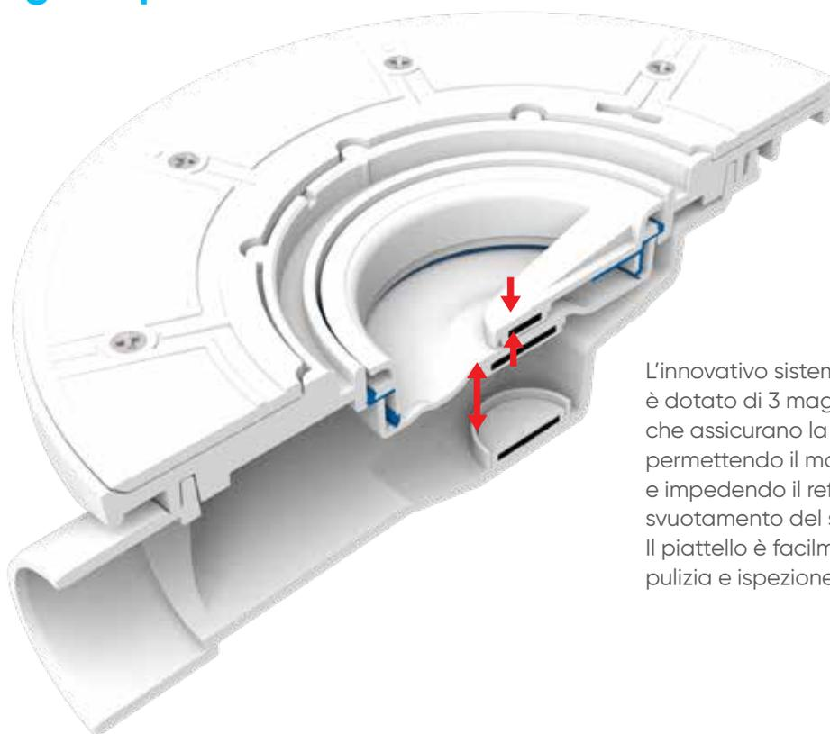
L'innovativo sistema **Magnetech**<sup>®</sup> è dotato di 3 magneti, con cariche opposte, che assicurano la massima efficienza permettendo il massimo deflusso dell'acqua e impedendo il reflusso di cattivi odori o lo svuotamento del sifone.
