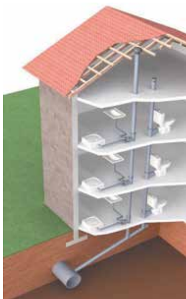
Esempio di posa su grossi diametri
