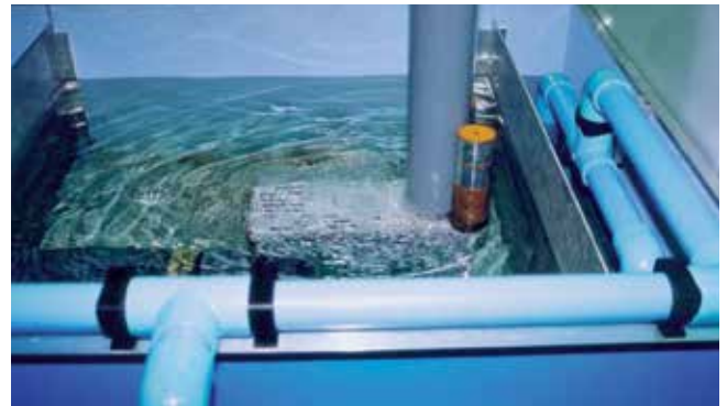
Prova di evacuazione su un pozzetto pluviale.
