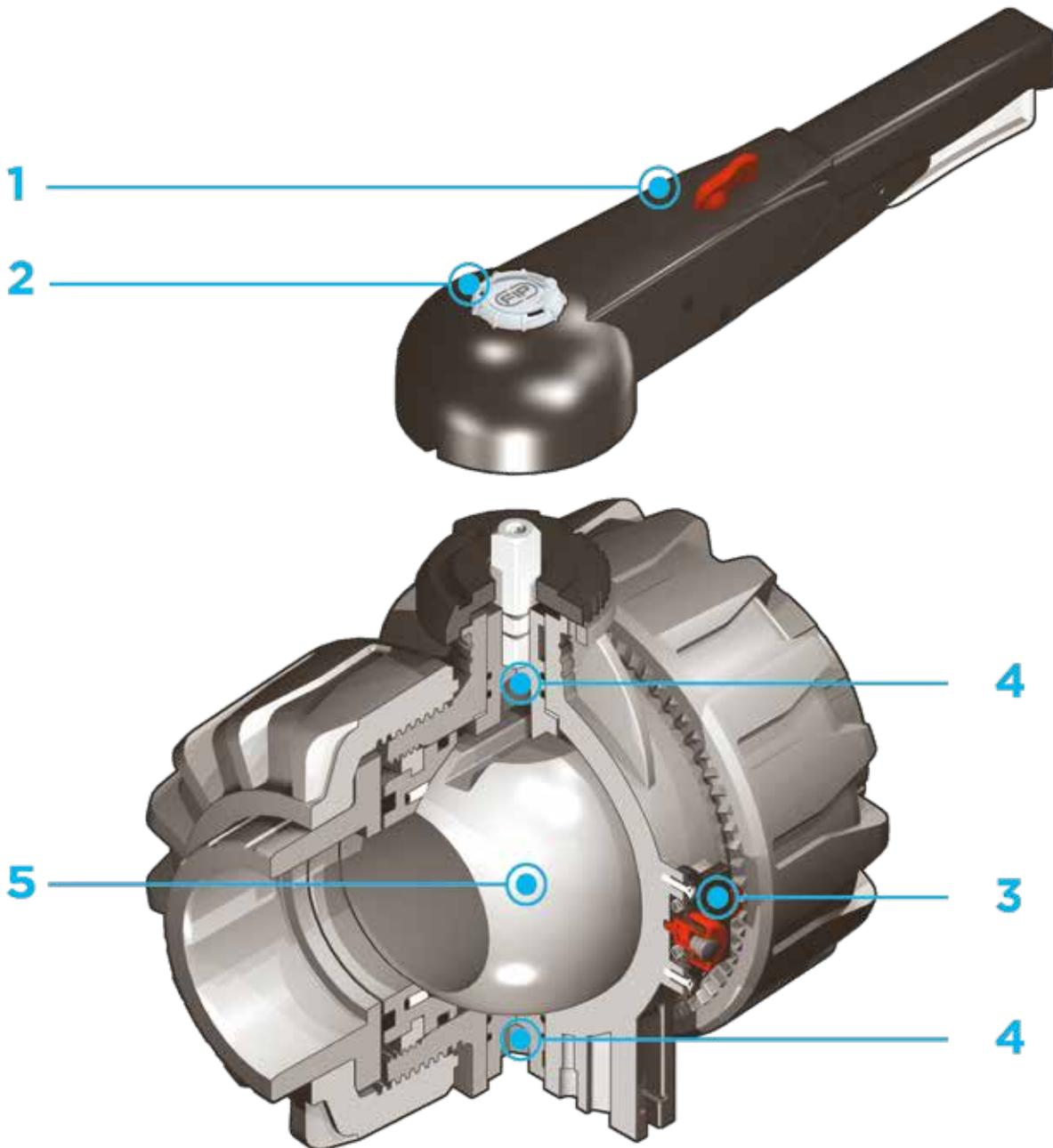
**1** Maniglia multifunzione ergonomica in HIPVC con possibilità di manovra rapida, **blocco e regolazione graduata in 10 posizioni**. Possibilità di inibire la rotazione apponendo un lucchetto
