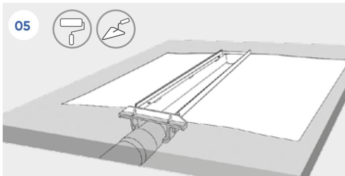
**IT** - Stendere il geotessile, se necessario stendere l'impermeabilizzante. **GB** - If necessary, place the membrane above the whole surface or use a liquid sealer.
