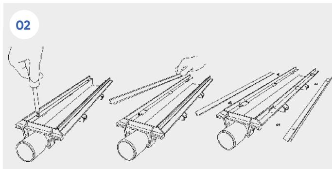
**IT** - Rimuovere i profili in acciaio Inox. **GB** - Remove the stainless steel rails.
