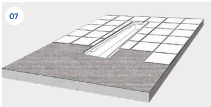
**IT** - Stendere il geotessile, se necessario stendere l'impermeabilizzante. **GB** - If necessary, place the membrane above the whole surface or use a liquid sealer.
