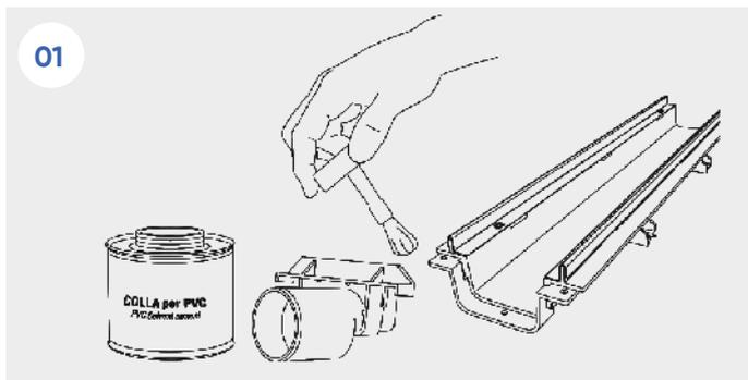
**IT** - Utilizzare una colla per PVC per il fissaggio dei canali e delle testate. **GB** - Use the specific PVC glue to connect the channels and the end cap outlet.
