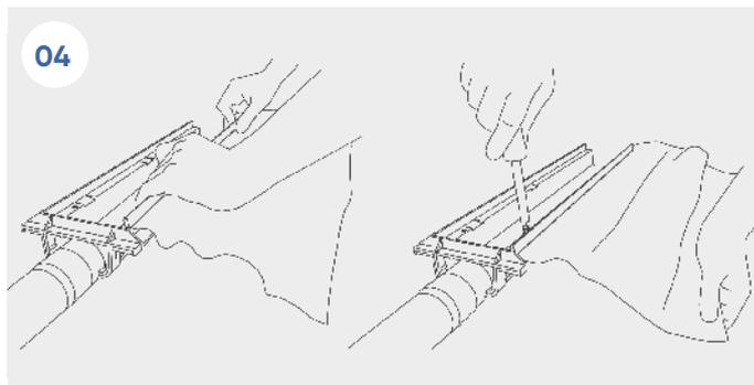
**IT** - Fissaggio del telo in geotessile (o membrana in PVC) tramite i profili in acciaio Inox. **GB** - Clamp the geotextile membrane (or PVC membrane) underneath the rails and tighten the screws.
